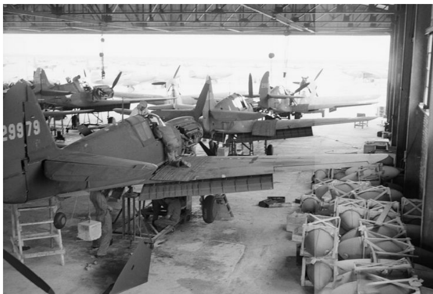
Збірка літаків-винищувачів Curtiss P-40 Warhawk на авіаскладальному заводі в Ірані, грудень 1942 року
