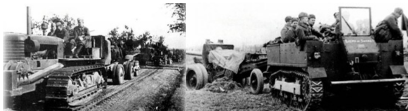
Транспортування гармат тягачами M1 Heavy Tractor і M5
