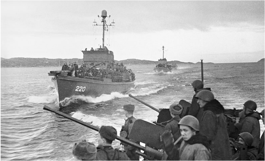
Радянські кораблі - великі мисливці за підводними човнами із встановленими на щоглах антенами РЛС SF-1
