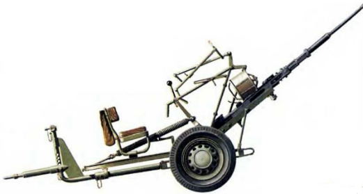
Зенітна гармата Oerlikon, калібру 20-мм
